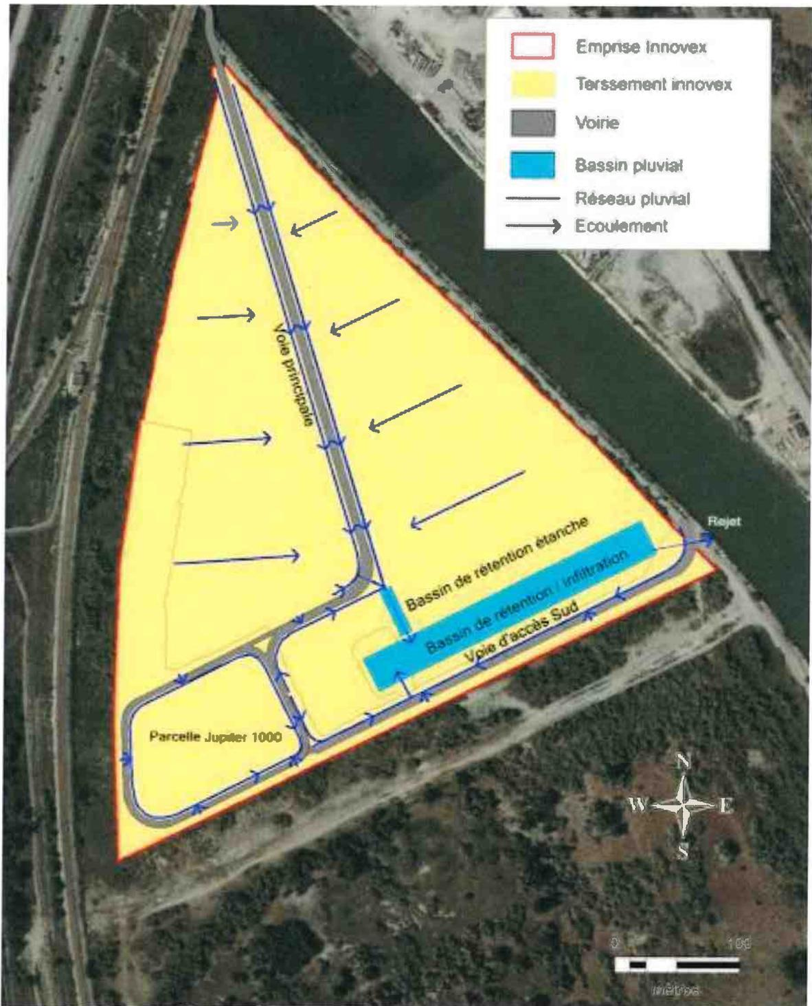
*Principe de gestion des eaux pluviales*
